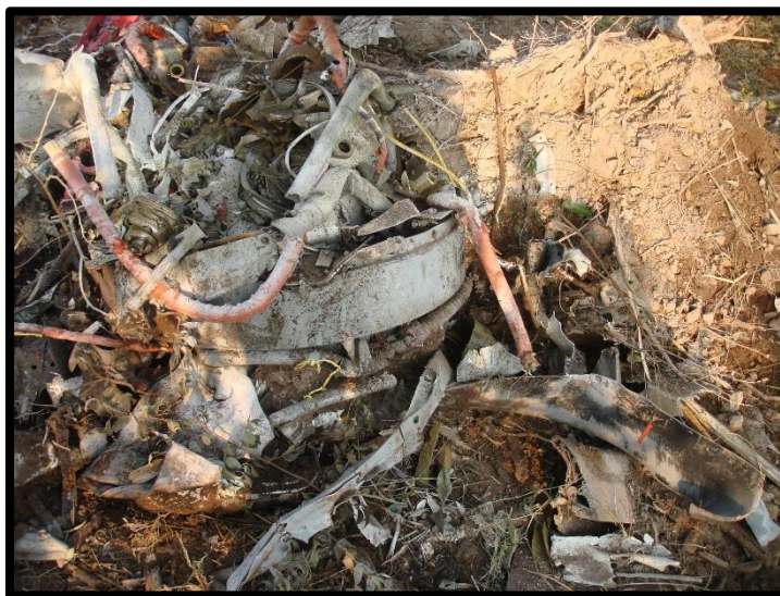
Fotografía No. 16 Vista del motor de la aeronave enterrado por el impacto.
