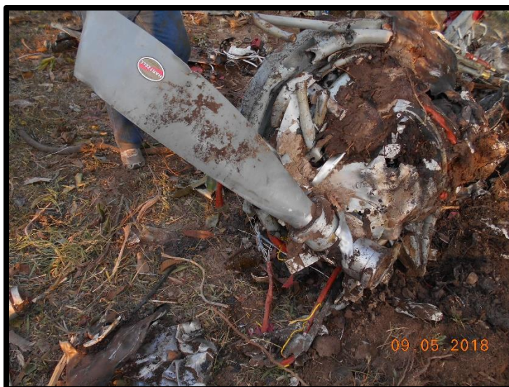
Fotografía No. 13 Vista del motor y hélice destruidos por impacto a tierra.
