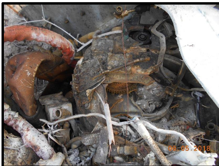
Fotografía No. 8 Motor destruido por la fuerza del impacto.
