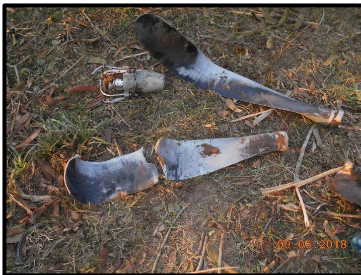
Fotografía No. 14 Vista de las aspas de la hélice fracturadas y dobladas.
